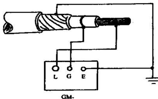
屏蔽电缆绝缘测试接线图
