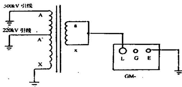
500kV 电力变压器低压绕组绝缘测试接线图
