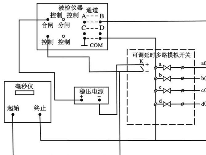
注：分闸时间测量接线时，被测仪器处于分闸接线方式。方法同合闸时间试验，误差计算相同
